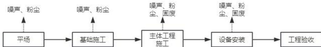
**图 2-2 施工期工艺流程及产污节点图**
